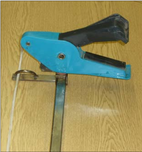
Abb. 10: Greifer zum Einbringen der Kupferelektroden. Durch Ziehen an der Leine wird der Greifer geschlossen.
