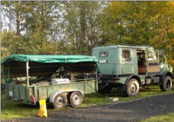
Abb. 6: Unimog des GGA-Institutes mit Generatoranhänger bei der Einspeisung.
